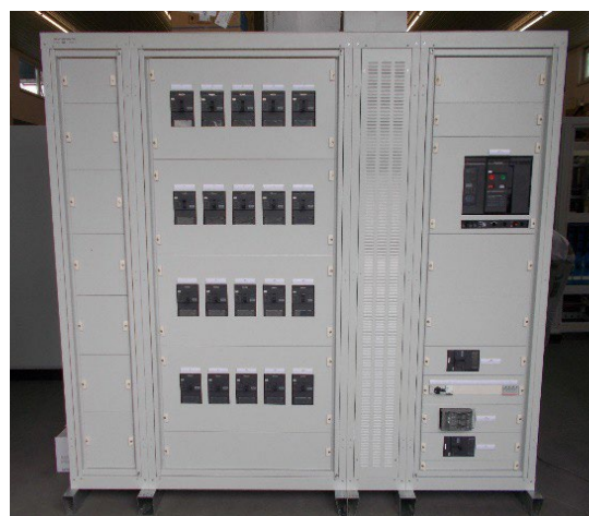
TGBT réalisé en fonction du design devis de gauche avec du matériel spécifique 800 VAC de la marque NADER type NDM5-250 V en 160 A pour les onduleurs, 125 A en protection parafoudre et disjoncteurs ouverts série NDW3-4000HU KM en 3200 A
