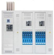
Exemple de réalisations de TGBT pour onduleurs 185KTL avec fusibles de protection Mersen en 160 A par phase, option Ampèremètre par sortie onduleur, analyseur multifonction, disjoncteurs ouverts de 800 A par groupe de 5 onduleurs, disjoncteurs ouverts de regroupement de 1600 A, disjoncteur ouvert général 3200 A
