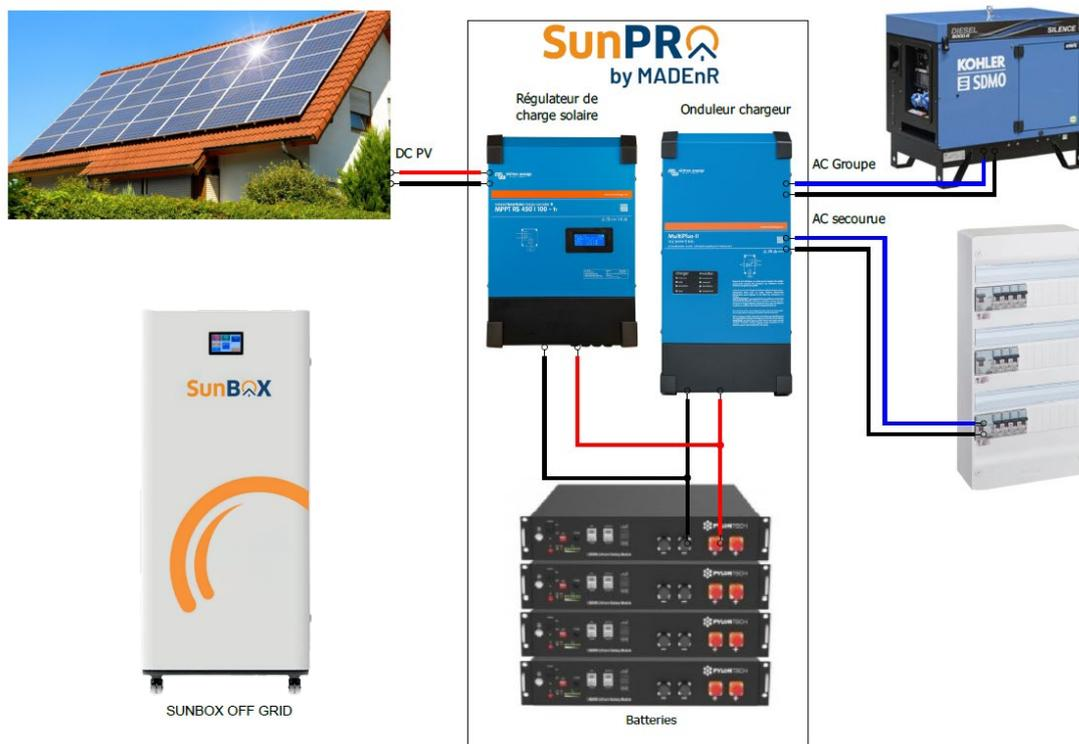
Figure 58 : Schéma de principe de la SunBox Off Grid
